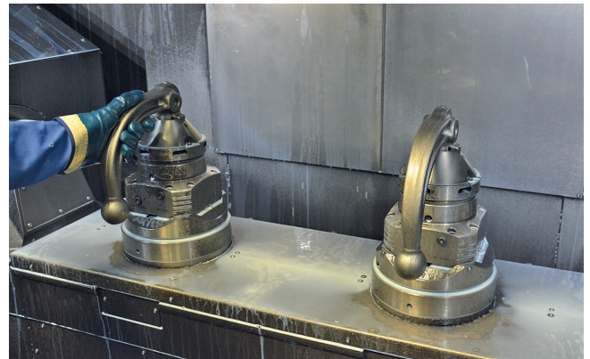
5 Zweite Aufspannung: Die angearbeiteten Kugelstangen werden aus Genauigkeitsgründen so gespannt, wie sie später am Kfz auch ins Halterrohr gesteckt werden © Hanser
