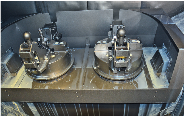
4 Erste Aufspannung: Die beiden Rohlinge werden in speziell gestalteten Achszug-Spannvorrichtungen fixiert © Hanser
